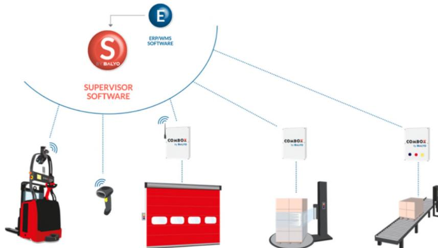
Le système de gestion prend en compte le gabarit des robots, crée le circuit en prenant en compte les informations fournies par l'installateur Balyo (i.e. les zones de stationnement interdites, passages piétons, portes incendie etc...) et optimise la circulation en temps réels des véhicules via un algorithme développé par la Société afin d'éviter les collisions et les bouchons entre robots.
